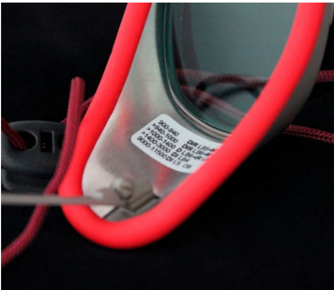
Abb. 7 Schutzstufenkennzeichnung nach EN 207 bei der Laser-Schutzbrille von Beispiel 6
