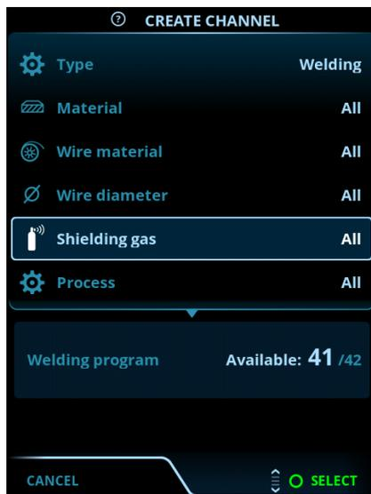
4. Verwenden Sie die Filteroptionen (z.B. Material, Drahtmaterial oder Drahtdurchmesser), um die für den Zweck am besten geeigneten Schweißprogramme zu finden.
