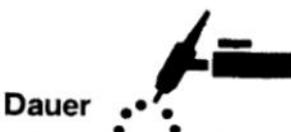
Beim Schliessen des Brennertasters beginnt die Gasströmung und die Zündimpulse werden erzeugt. Der Schweißstrom geht auf den eingestellten Wert.
